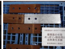
リン酸塩処理と自然発生赤錆
